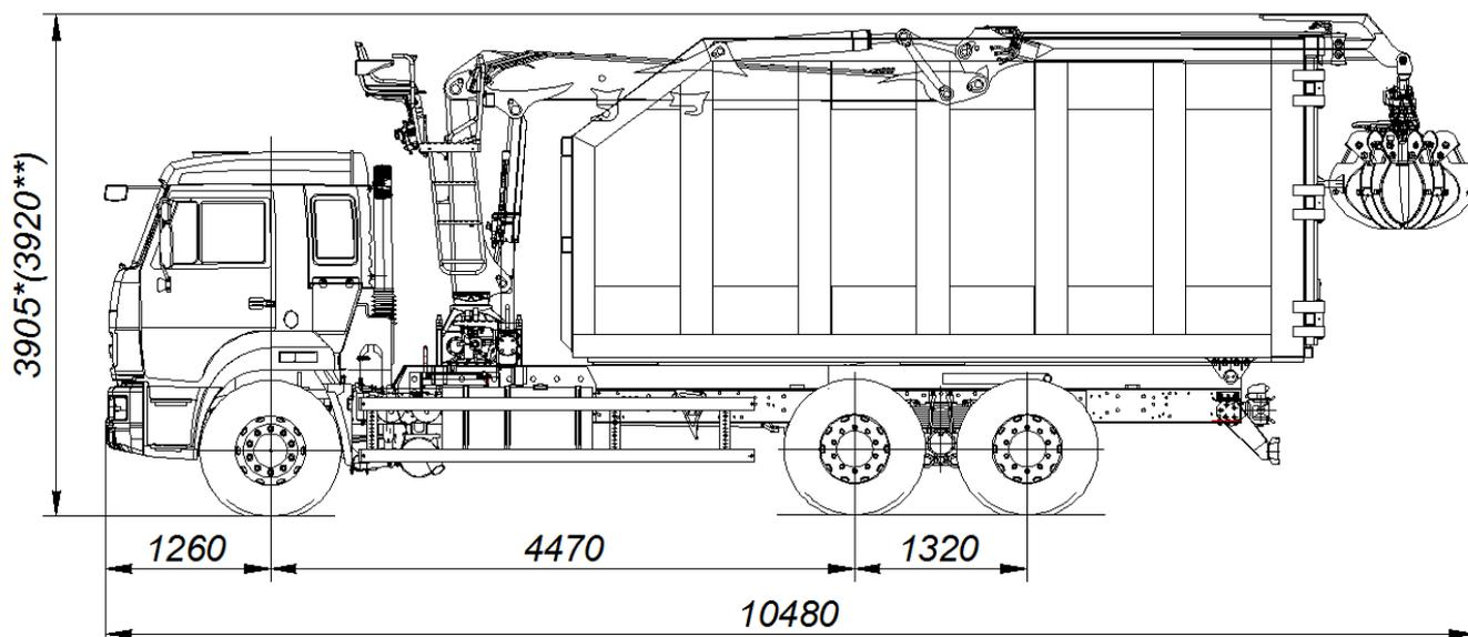
Размеры для автомобиля снаряженной массы: \* - с шинами 11.00 R22,5/ \*\* - с шинами 11.00 R20
