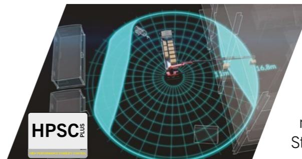
HPSC-Plus LOAD gewährleistet, dass in jeder Situation die beste Leistung des Kranes bei voller Standsicherheit erreicht wird. Egal ob das Fahrzeug unbeladen, teilbeladen oder voll beladen ist, HPSC-Plus LOAD übernimmt je nach Erfordernis automatisch die Aufgaben der Standsicherheitsüberwachung.
