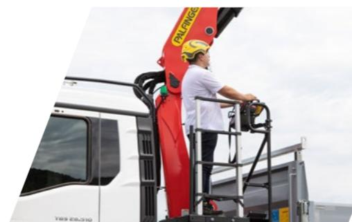
Optimale Übersicht und ein guter Schutz zeichnen den Hochstand nach EN12999:2011 aus. Die vorgesehene Halterung für die Funkfernsteuerung sorgt für eine sichere und präzise Bedienung des Krans. In dieser Position hat der Bediener alles bestens im Blick. Die Funkfernsteuerung bietet ihm darüber hinaus absolute Flexibilität.
