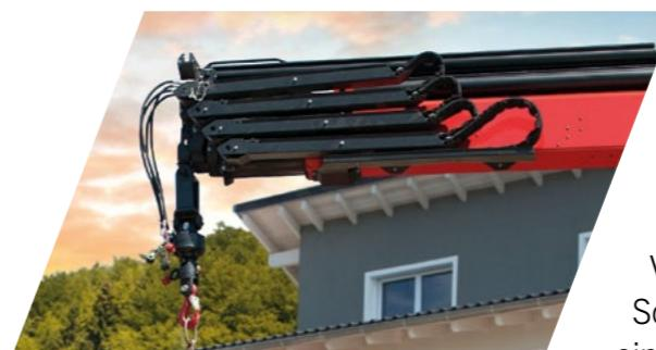
Mit den vorinstallierten Anschlüssen können schnell Zusatzgeräte, wie beispielsweise ein Greifer angeschlossen werden. Durch diese Crane Tools kann der Einsatzbereich des Ladekrans erweitert werden. Zusätzlich bietet die Verlegung der Schlauchausrüstung in geführten Schlauchwannen einen langfristigen Schutz und einen sicheren Einsatz.
