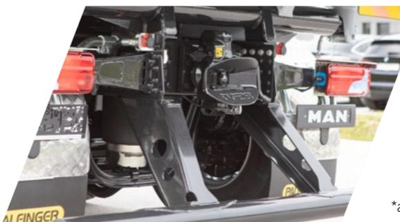
Mittels der Ringfeder-Anhängerkupplung können Anhänger mit einem Gesamtzuggewicht von bis zu 40\* Tonnen bewegt werden. Daraus wird aus diesem Fahrzeug ein wahres Multitalent mit einem erweiterten Einsatzbereich.
