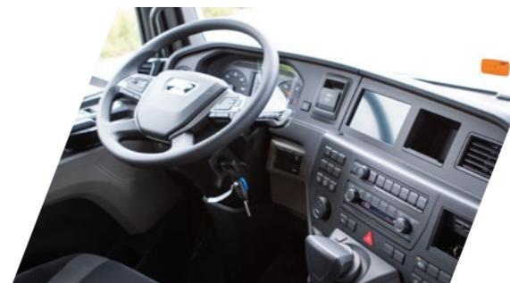
Das moderne Vierspeichen-Multifunktionslenkrad kann individuell auf die Sitzposition des Fahrers in Höhe und Neigung eingestellt und zum leichten Ein- und Ausstieg weggeklappt werden. Die ergonomischen Tasten sorgen für eine einfache und bequeme Bedienung zahlreicher Funktionen, wie beispielsweise Tempomat und Speedlimiter.
