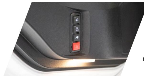
Die zusätzliche Anordnung von vier Tasten auf der Fahrertür erhöht den Komfort im Arbeitsalltag erheblich. Dadurch können wichtige und häufig benötigte Fahrzeugfunktionen weiterhin ergonomisch bedient werden, ohne erneut in die Fahrzeugkabine einsteigen zu müssen.
