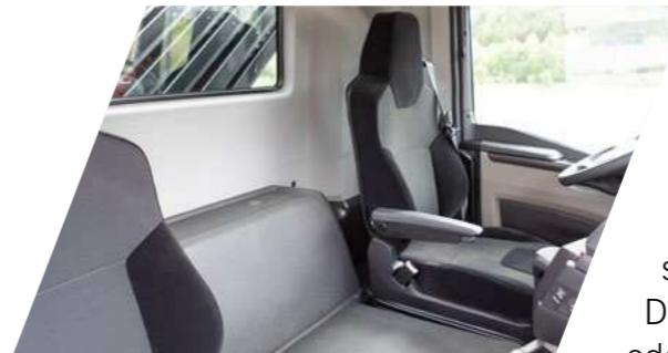
Der luftgefedeerte Fahrerkomfortsitz mit Lenzenwirbelstütze, Schulteranpassung und integrierter Kopfstütze, bietet eine neunstufige und gewichtsabhängige Sitzhöheneinstellung. Die Memory- und Schnellabsenkungsfunktion sorgen für ein komfortables ein- und aussteigen. Die Vertikaldämpfung kann individuell eingestellt oder komplett blockiert werden.
