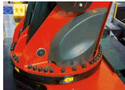
Endlosschwenkwerk Uneingeschränkte Bewegung
