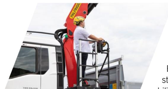
Optimale Übersicht und ein guter Schutz zeichnen den Hochstand nach EN12999:2011 aus. Die vorgesehene Halterung für die Funkfernsteuerung sorgt für eine sichere und präzise Bedienung des Krans. In dieser Position hat der Bediener alles bestens im Blick. Die Funkfernsteuerung bietet ihm darüber hinaus absolute Flexibilität.
