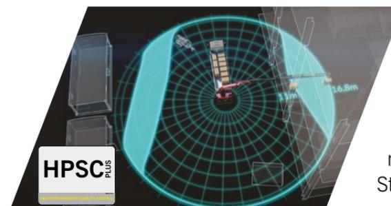
HPSC-Plus LOAD gewährleistet, dass in jeder Situation die beste Leistung des Krans bei voller Standsicherheit erreicht wird. Egal ob das Fahrzeug unbeladen, teilbeladen oder voll beladen ist, HPSC-Plus LOAD übernimmt je nach Erfordernis automatisch die Aufgaben der Standsicherheitsüberwachung.
