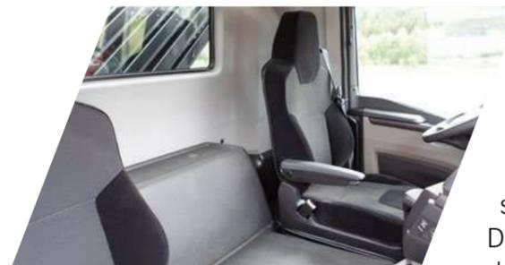
Der luftgefederte Fahrerkomfortsitz mit Lendenwirbelstütze, Schulteranpassung und integrierter Kopfstütze, bietet eine neunstufige und gewichtsabhängige SitzhöhenEinstellung. Die Memory- und Schnellabsenkungsfunktion sorgen für ein komfortables ein- und aussteigen. Die Vertikaldämpfung kann individuell eingestellt oder komplett blockiert werden.
