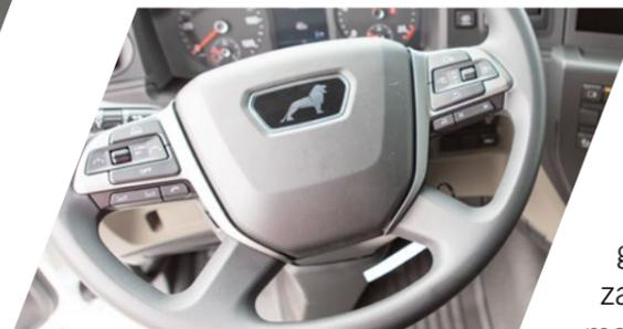
Das moderne Vierspeichen-Multifunktionslenkrad kann individuell auf die Sitzposition des Fahrers in Höhe und Neigung eingestellt und zum leichten Ein- und Ausstieg weggeklappt werden. Die ergonomischen Tasten sorgen für eine einfache und bequeme Bedienung zahlreicher Funktionen, wie beispielsweise Tempomat und Speedlimiter.
