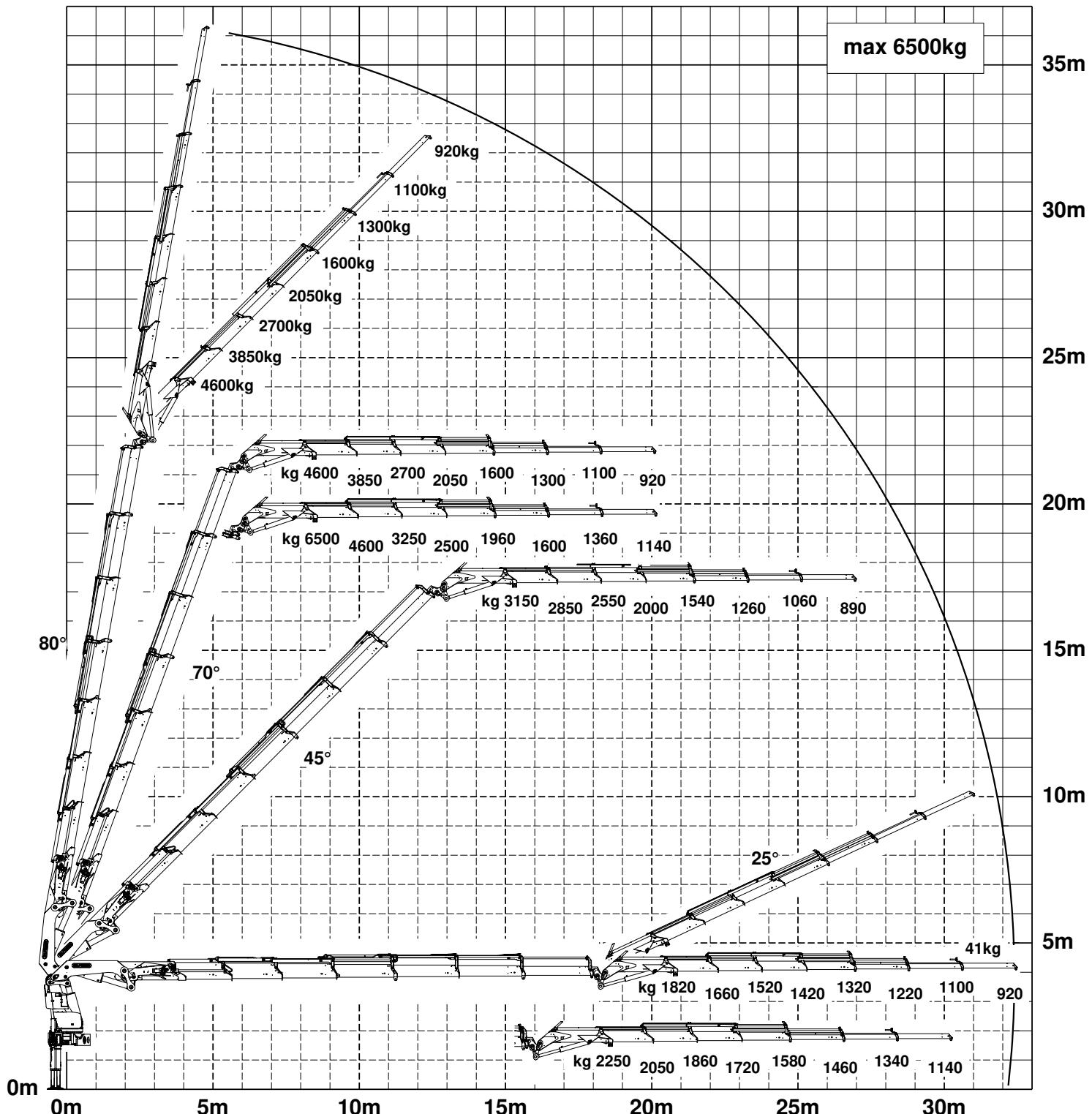
Die Tragkräfte laut Diagramm verringern sich bei Verwendung von mechanischen Verlängerungen um deren Eigengewicht.
