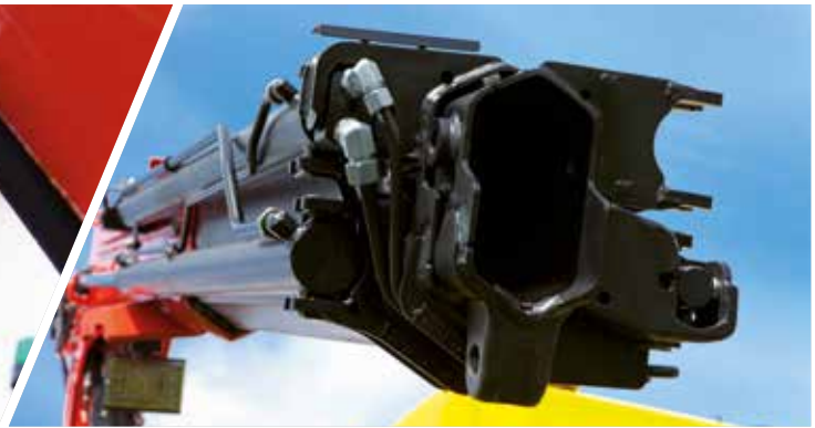
Seitlich angeordnete Zylinder Geringe Gesamthöhe
