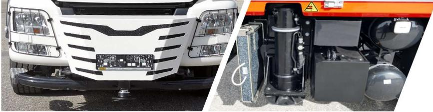
Die Zusatzabstützung und die Frontstütze sorgen für eine maximale Standsicherheit des Fahrzeuges und beste Kranperformance.
