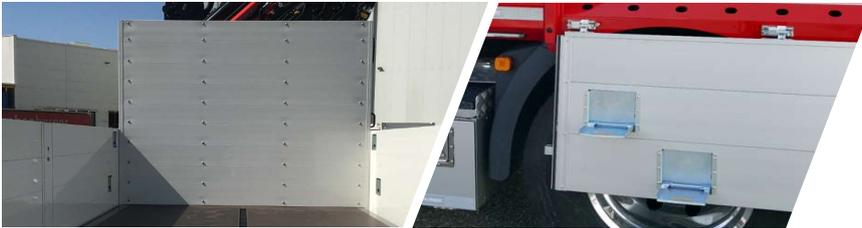
Eine Stirnwand und Bordwände aus Alu-Profilen umrahmen die Pritsche. Die Ladefläche ist über integrierte Klappritte einfach zu erreichen.
