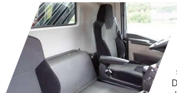
Der luftgefederte Fahrerkomfortsitz mit Lendenwirbelstütze, Schulteranpassung und integrierter Kopfstütze, bietet eine neunstufige und gewichtsabhängige Sitzhöhereinstellung. Die Memory- und Schnellabsenkungsfunktion sorgen für ein komfortables ein- und aussteigen. Die Vertikaldämpfung kann individuell eingestellt oder komplett blockiert werden.
