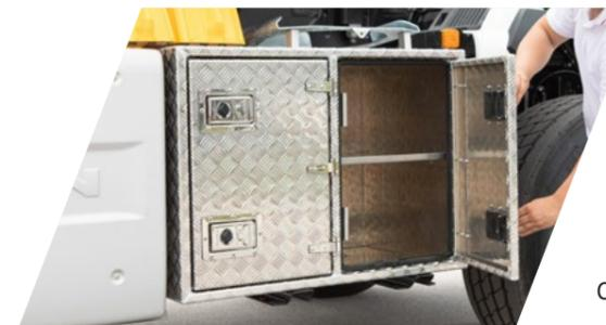
Ausreichend Platz für die Lagerung von Kranzubehör und Lastaufnahmemittel bietet die robuste Werkzeugbox aus Edelstahl. Sperrige Gegenstände wie Besen und Schaufel sind sicher am Kotflügel mittels Halterung befestigt. Für höheren Komfort sind die Unterlegplatten direkt an der Kranabstützung angebracht.
