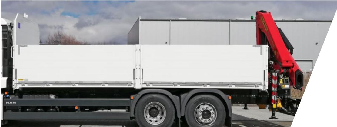
Die nach DIN EN 12642 Code XL geprüfte Baustoffpritsche wird auf dem Hilfsrahmen aufgesetzt.
