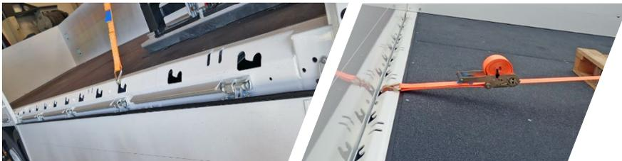
Das schräge Außenumrandungsprofil mit "Schlüsseloch" ermöglicht ein Ein- und Aushängen der Zurrgurte bei geschlossenen Bordwänden.
