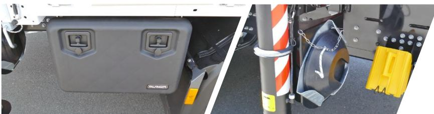
Kranzubehör und Lastaufnahmemittel können sicher in einer Kunststoffbox aufbewahrt werden. Die Unterlegplatten sind an der Kranabstützung angebracht, sodass diese mitfahren und bequem in Position gebracht werden können.
