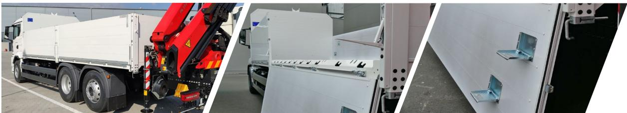
Die Ladung ist bestens durch 1000mm hohe Alu-Bordwände geschützt, die über Gasdruckdämpfer einfach gehoben werden können. Die Ladefläche ist über Klapptritt und Handgriffe einfach zu erreichen. In einer speziellen Konsole auf der Stirnwand wird das Kranschubsystem sicher für den Transport abgelegt.
