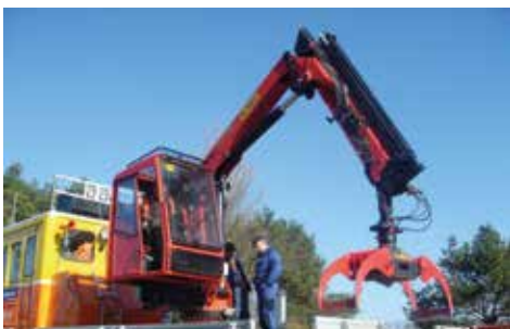
HOLZGUTGREIFER ZUM POSITIONIEREN VON SCHWELLEN UND SCHIENENSTÜCKEN
