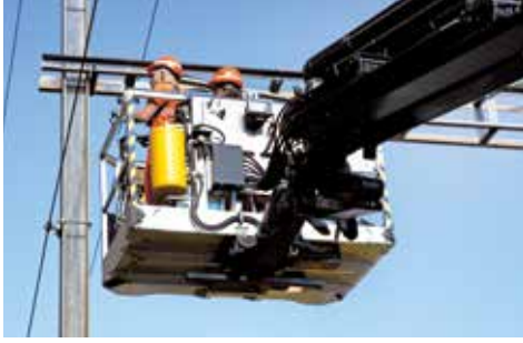
ARBEITSKÖRBE FÜR ARBEITEN AN DER OBERLEITUNG
