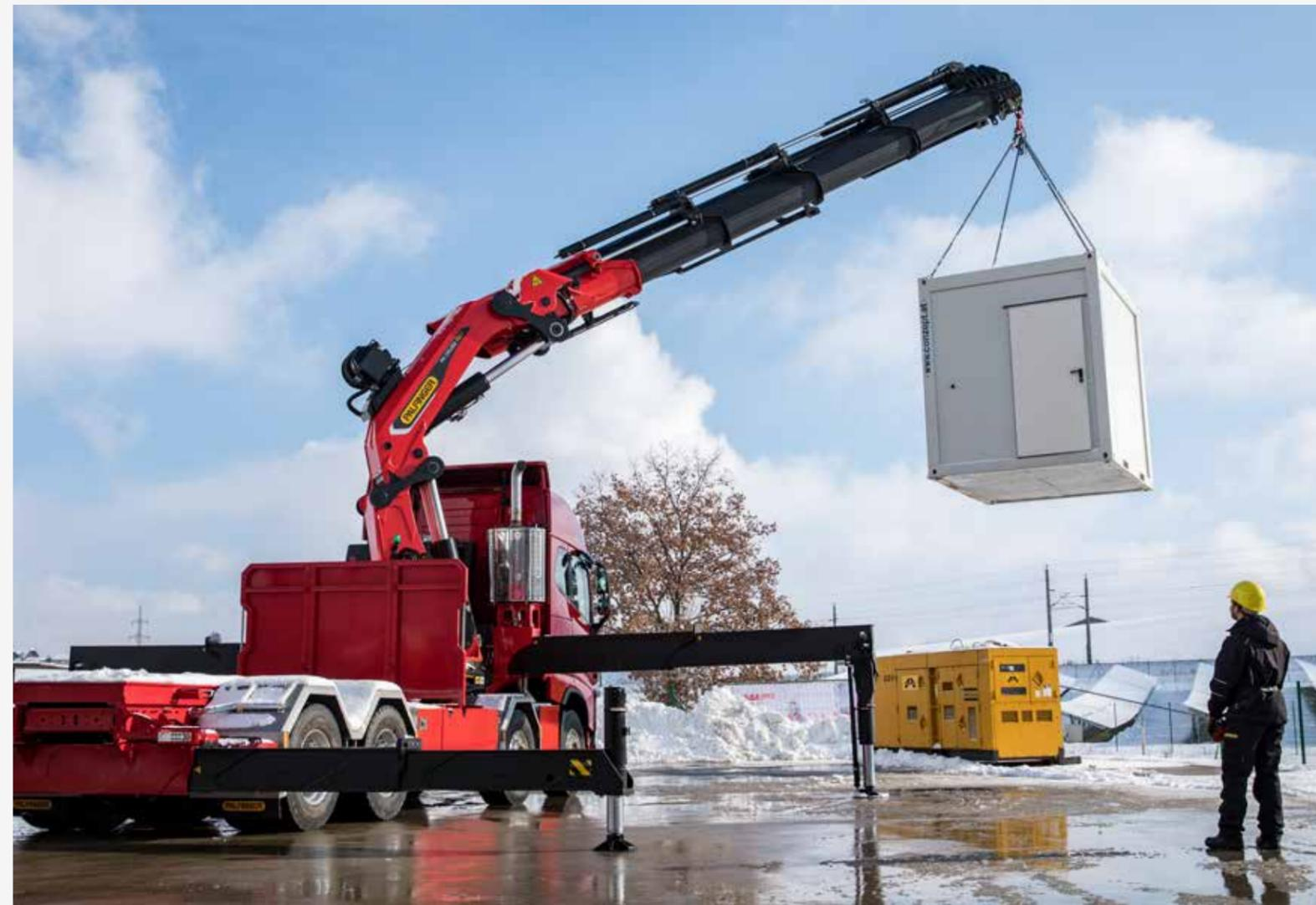
optimise la surveillance de la stabilité de la grue en prenant en compte la portée de la grue. Lorsque le véhicule n'est pas complètement stabilisé ou que la portée est moindre, la force de levage s'en trouve considérablement augmentée.
