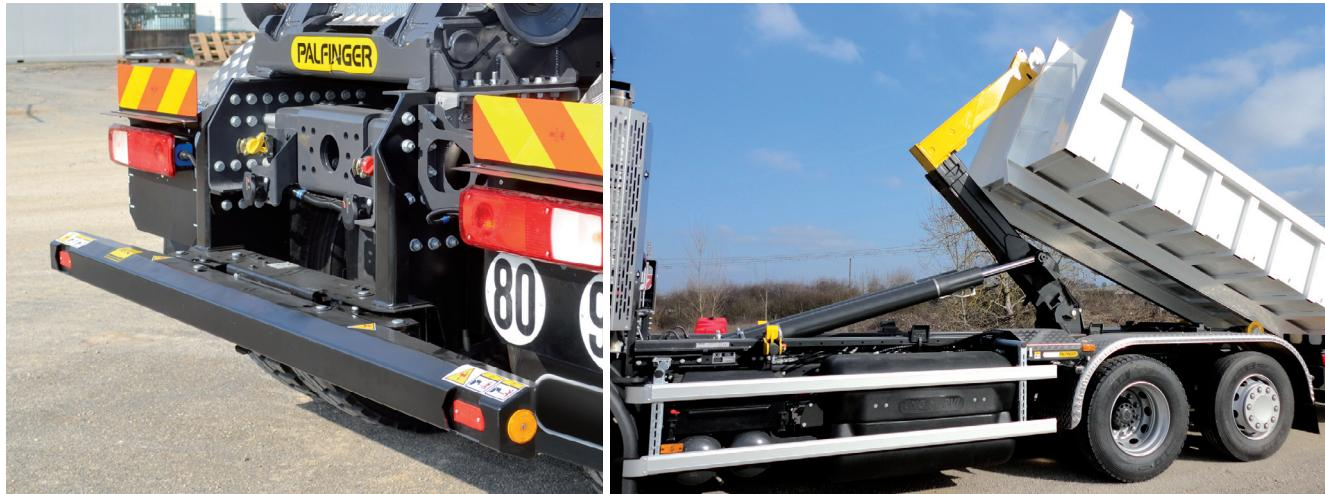
PALFINGER verwendet korrosiongeschützte und schraubbare Montagesysteme sowie Anbauteile.
