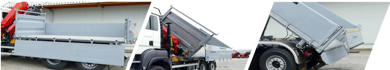
Die Bordwände sind pendeln und abklappbar ausgeführt, um auch eine einfache Beladung mit einem Gabelstapler zu ermöglichen. Die Heckwand öffnet automatisch bei angehobener Kipperbrücke und schließt beim Absenken. Auf der starren Stirnwand ist eine höhenverstellbaren Kommunal-Aufsatz angebracht.
