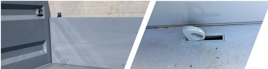
Die Ladung kann über Zurrösen im Boden und in der Stirnwand gesichert werden.
