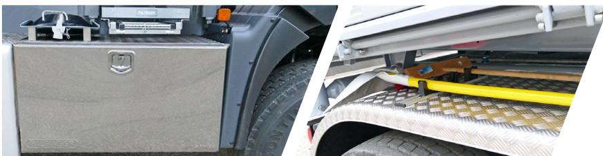
Kranzubehör und Lastaufnahmemittel können sicher in der Werkzeugkiste aus Edelstahl aufbewahrt werden. Am Kotflügel ist noch ein Halter zur Befestigung von Besen und Schaufel angebracht.
