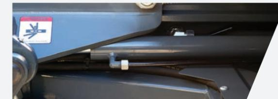
Les cylindres de portage sont situés et encastrés sous le mât de portage, contribuant à un centre de gravité plus bas de la machine, tout en protégeant des dégâts et de l'abrasion dus aux chutes de débris de produit.
