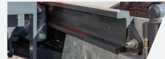
Les canaux en acier laminé de la structure principale ont un diamètre de taille large standard 4. Ce canal de la structure principale solide permet l'utilisation de rouleaux de portage du mât plus larges avec des diamètres plus grands, ce qui réduit l'usure du canal.
