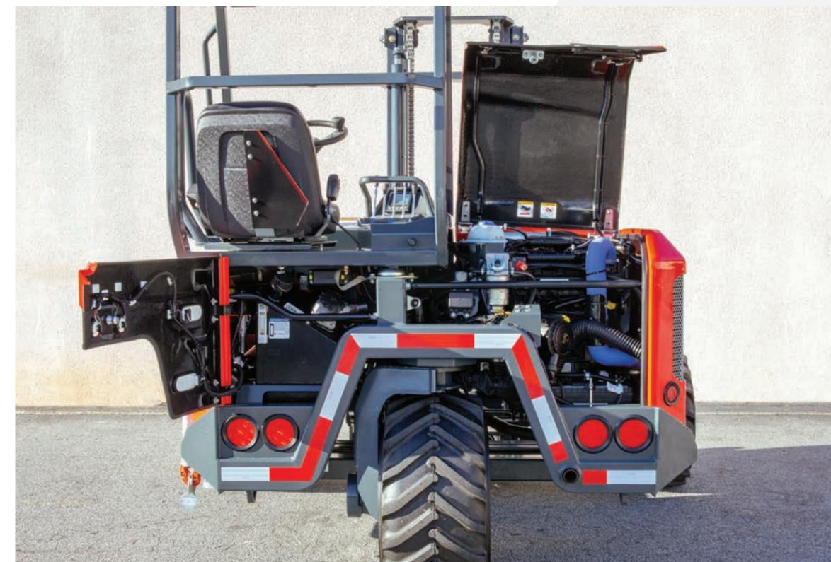
Tous les systèmes PALFINGER sont conformes aux plus hauts standards industriels. Les connexions électriques ont une classification IP68. La tuyauterie hydraulique est réduite au minimum avec une utilisation extensive des conduites hydrauliques en acier partout pour minimiser les fuites.
