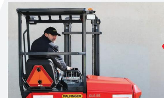
La position du siège de 5° vers l'intérieur réduit les mouvements et la tension pour le cou durant la marche arrière tout en améliorant le champ de vision arrière de l'opérateur.
