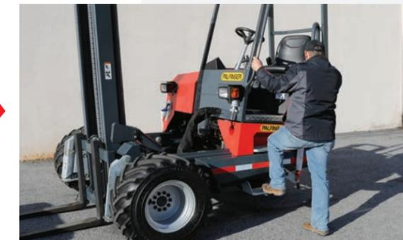
Pivoter le siège opérateur de 25° vers l'extérieur améliore considérablement la grille d'entrée et de sortie de la cabine.
