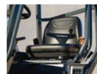
Siège Milsco® de luxe avec ceinture de sécurité haute visibilité et protection latérale intégrée
