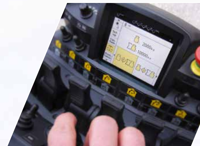
El último resultado del pesaje se muestra por encima del peso total.
