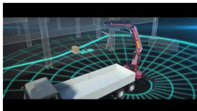
Cuando el camión está descargado, el palet puede elevarse hasta un alcance de 11 m
