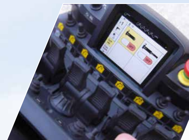
Es posible integrar tanto una como dos extensiones mecánicas en el sistema de protección de sobrecarga
