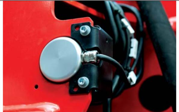
Auch die Zusatzabstützungen werden mit proportionalen Wegmessensoren ausgestattet und in das HPSC integriert. So entsteht ein effizientes Gesamtsystem.
