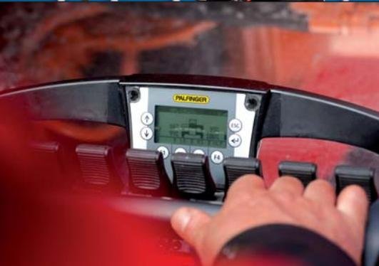
Das HPSC-System berechnet zu jedem beliebigen Schwenkwinkel des Armsystems und für jede beliebige Abstützsituation den zulässigen Arbeitsbereich. Basierend auf einem von PALFINGER entwickelten, intelligenten Rechenalgorithmus arbeitet es effizienter als vergleichbare am Markt erhältliche Systeme.
