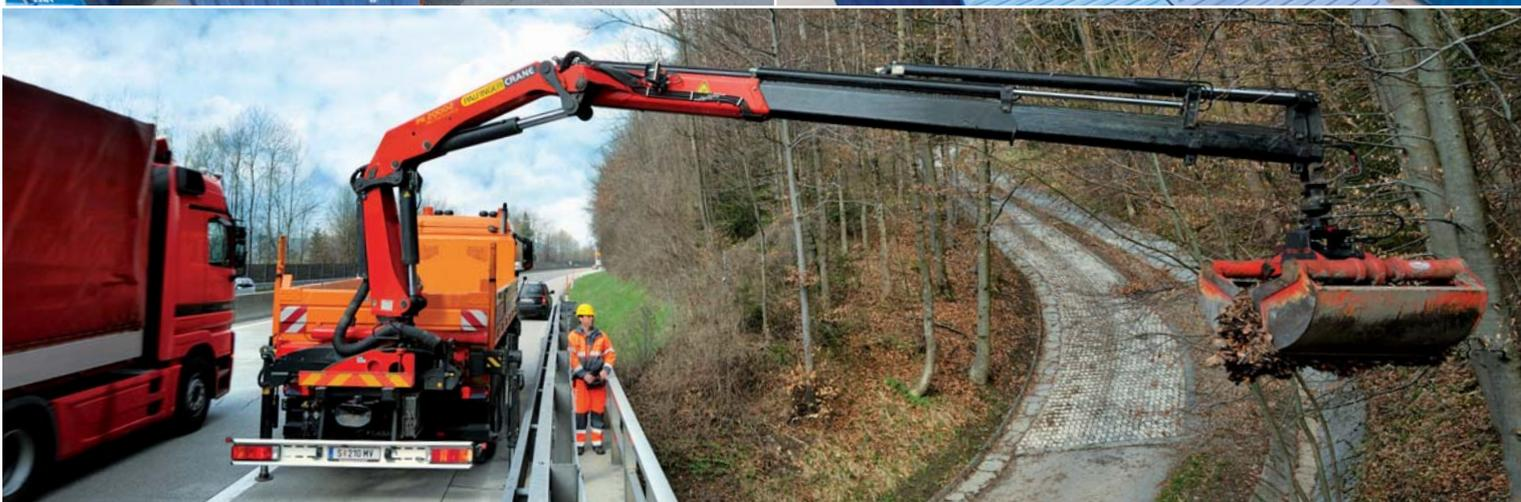
„HPSC“ bedeutet für den Kranfahrer ein Maximum an Komfort und Sicherheit – auch bei Kraneinsätzen unter eingeschränkten Platzverhältnissen. In stark verbauten Gebieten, im fließenden Verkehr oder ähnlichen Situationen kann das Fahrzeug oft nur auf eine Seite, teilweise oder gar nicht abgestützt werden.
