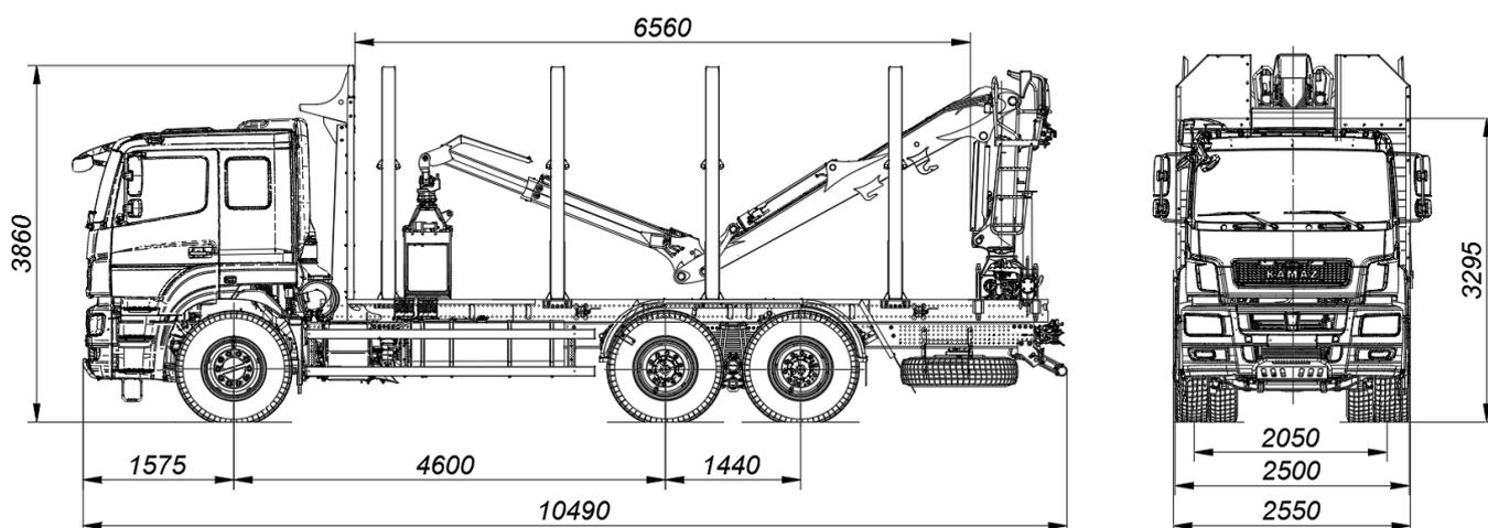
Размеры для автомобиля снаряженной массы: - с шинами 12.00R24
