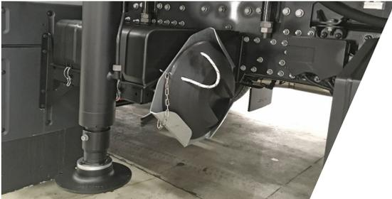
Die Stützplattenhalter sind griffbereit in der Nähe der Kranabstützung montiert.
