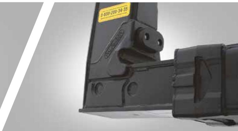
**Литая вставка и толкатель.** Литая вставка в углу крюковой стрелы убирает концентраторы напряжений. Толкатель демпфирует возможные удары.
