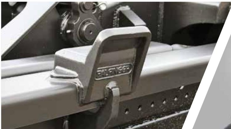
**4 литые опоры.** Износостойкие опоры предотвращают боковое смещение бункера при транспортировке.
