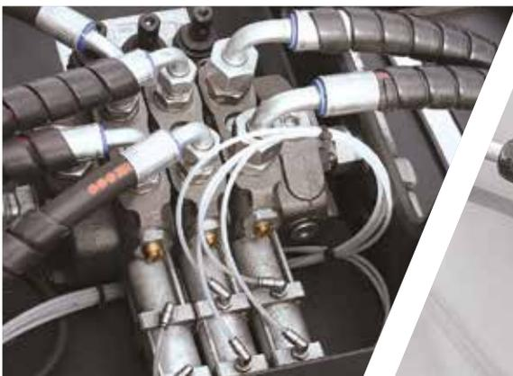
**Гидрораспределитель с пневматическим / электроуправлением.** Простая и надежная система управления.
