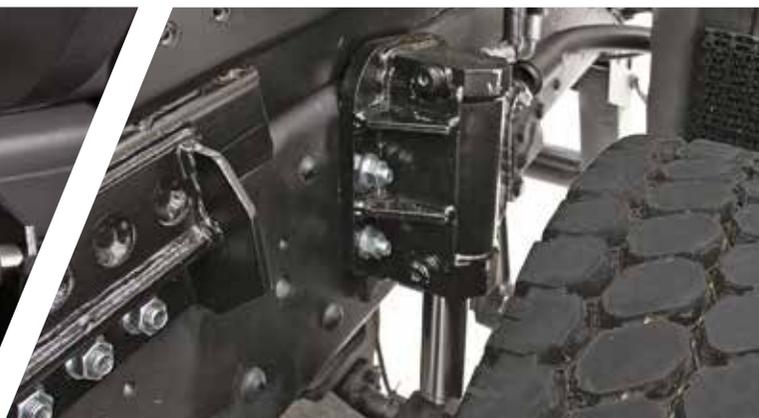
**Контроль подключения системы стабилизации.** Уменьшает вероятность отрыва от земли передних колес шасси при работе с бункером.
