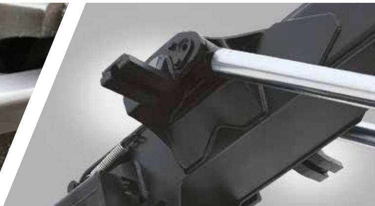
**Дополнительные опоры на средней раме.** Конструкция позволяет увеличить надежность фиксации бункера при работе в самосвальном режиме (особенно при разгрузке на неровных площадках).
