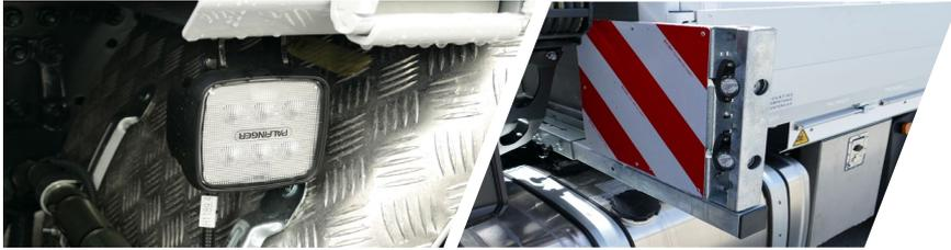
Für die optimale Ausleuchtung des Einsatzortes sorgen 4 Arbeitsscheinwerfer. Die Überbreitenwarntafeln sind mit Umrissleuchten ausgestattet.
