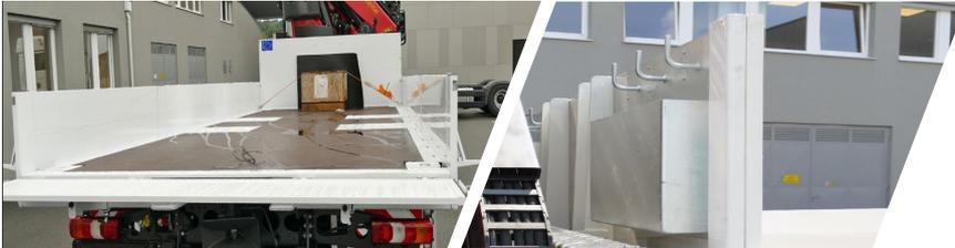
Die Pritsche wird von Bordwänden aus lackierte Aluprofile umrahmt. 2 Staukästen mit integrierten Haken an der Außenseite der Stirnwand bieten Ablagemöglichkeiten für Zurrmittel.
