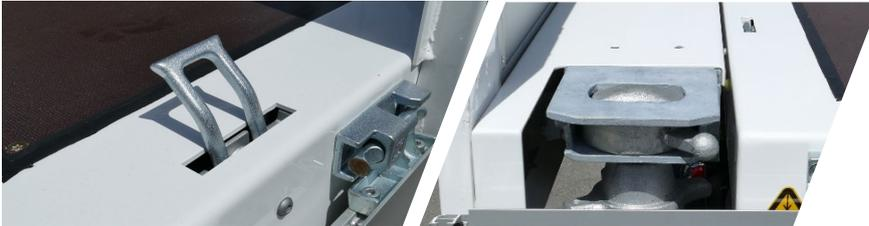
Zurrhaken, manuell ausziehbare Containerverriegelungen bieten beste Voraussetzungen für den sicheren Transport schwerer und breiter Güter.
