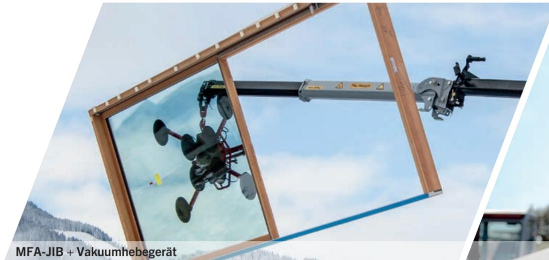
MFA-JIB + Vakuumhebergerät
