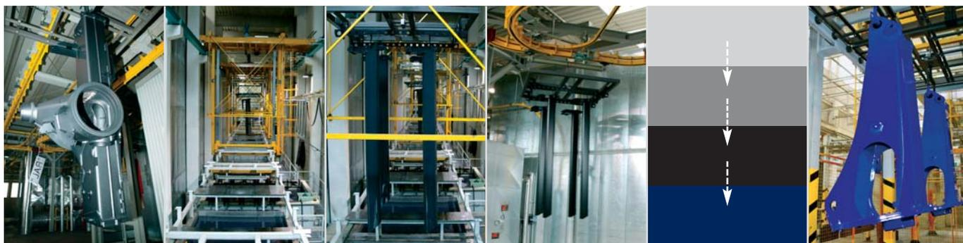
Base tratada con chorro de granalla de acero prepara para el proceso de inmersión.
