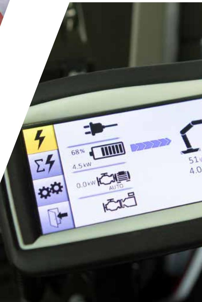
Un bon aperçu de l'état de fonctionnement et du niveau de chargement de la batterie en permanence.
