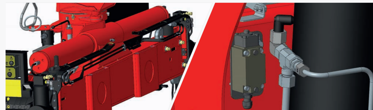
РВД аутригеров размещены в защитном кожухе РВД уложены в специальные лотки, которые обеспечивают их сохранность в процессе эксплуатации
