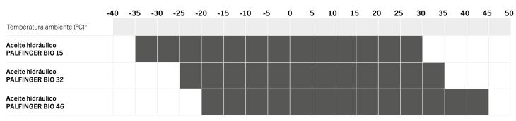
Sujeto a una temperatura de operación máxima de 80 °C.
