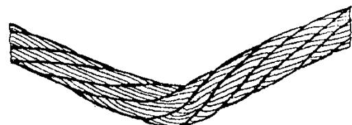
Рис.30: Залом каната (перегиб)
