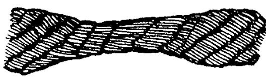
Рис.28: Раздавливания каната
