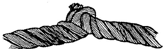
Рис.29: Перекручивание каната
