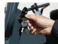
Encienda el motor con la llave de encendido a la altura del suelo
