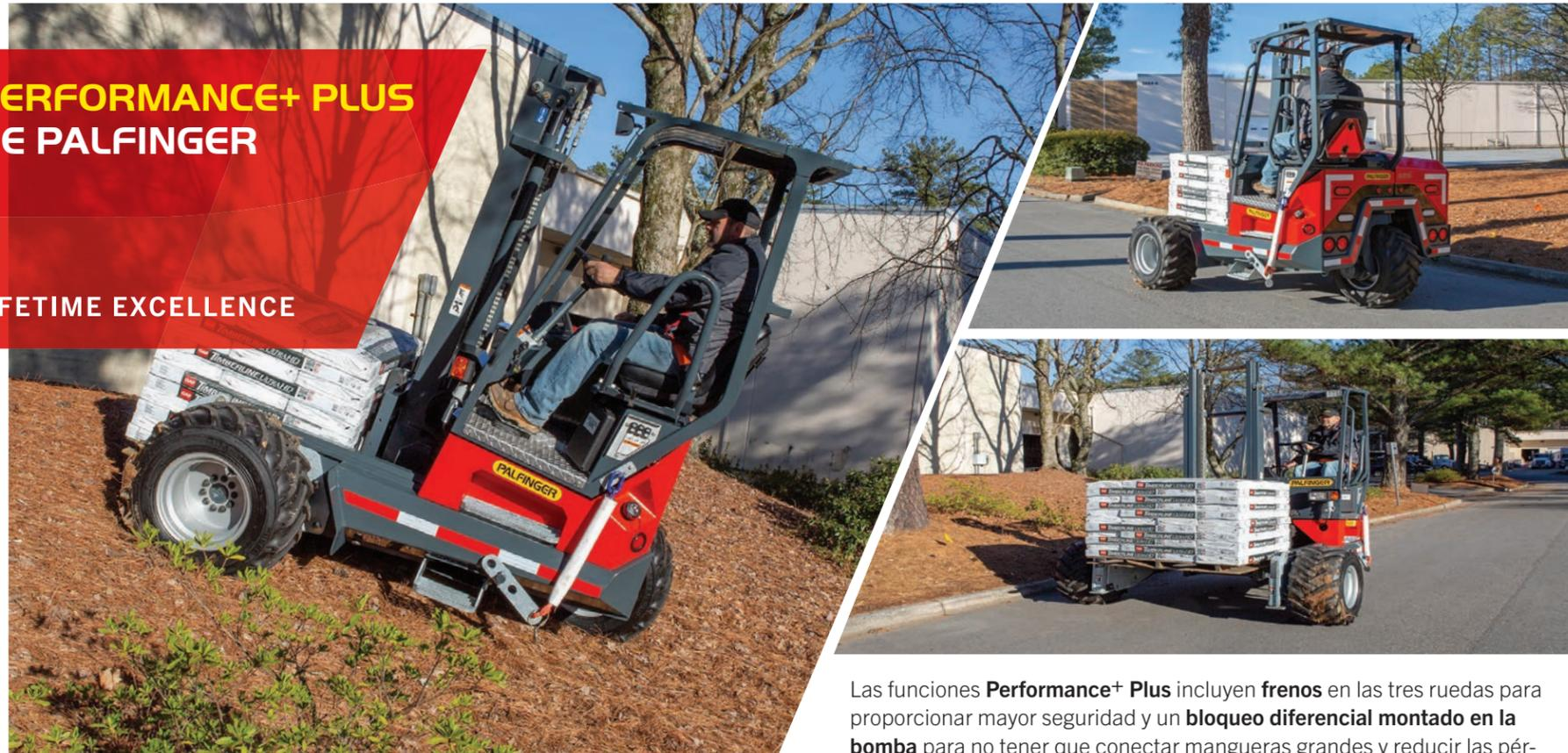
Las funciones **Performance+ Plus** incluyen **frenos** en las tres ruedas para proporcionar mayor seguridad y un **bloqueo diferencial montado en la bomba** para no tener que conectar mangueras grandes y reducir las pérdidas de fluido hidráulico.
