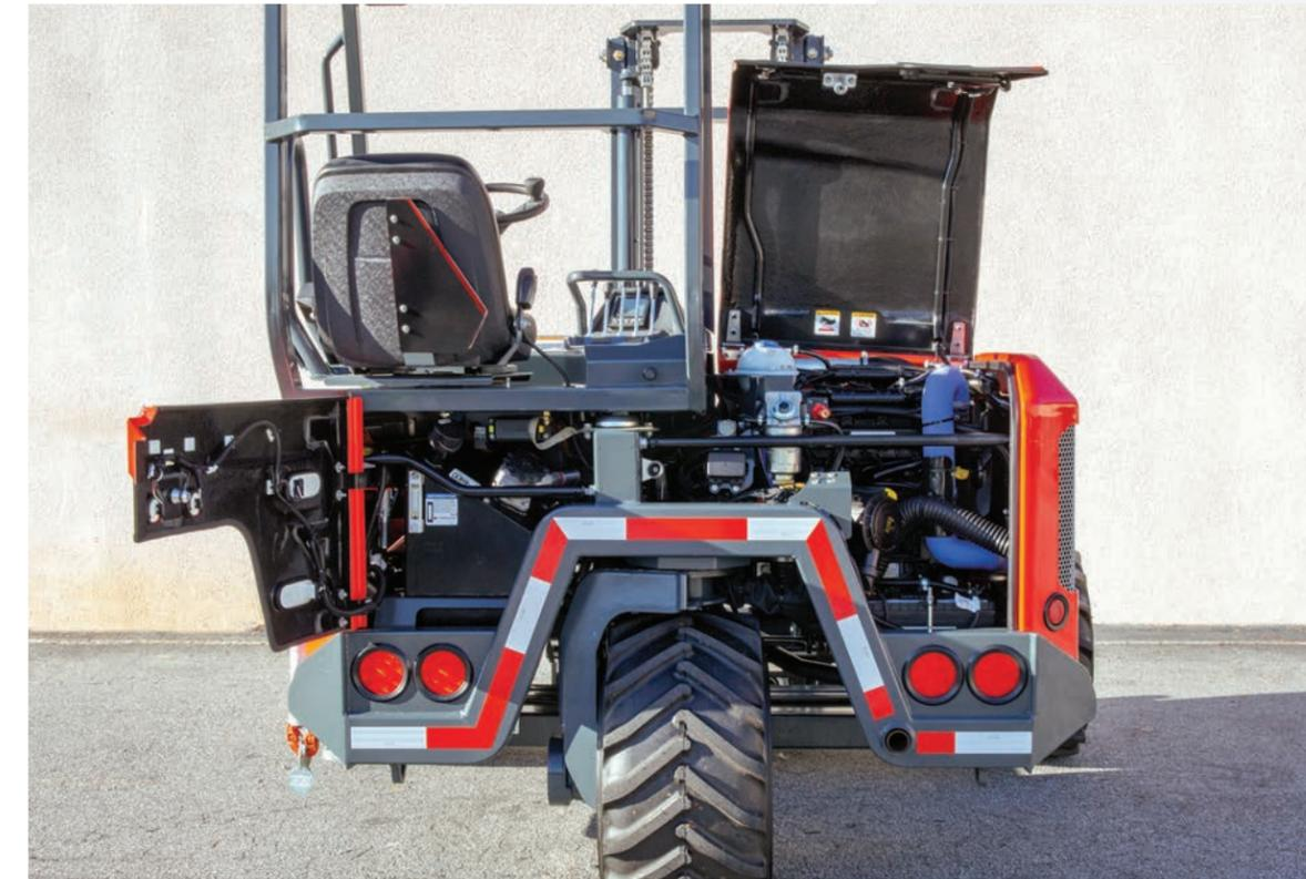
Todos los sistemas de PALFINGER cumplen con los más altos estándares de la industria. Las conexiones eléctricas tienen clasificación IP68. Mínima cantidad de mangueras hidráulicas y amplio uso de tuberías hidráulicas de acero en toda la máquina para minimizar las pérdidas.
