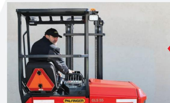
La posición de 5° del asiento interior reduce el movimiento del cuerpo y la tensión del cuello cuando se conduce en reversa. Además, aumenta el campo visual trasero del operador.
