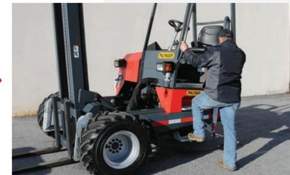
Rotar el asiento del operador 25° hacia afuera aumenta significativamente el espacio de entrada y salida de la cabina.
