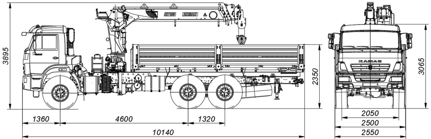
Размеры для автомобиля снаряженной массы: - с шинами 425/85R21
