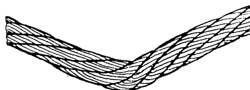
Рисунок 2.9.9 Залом каната (перегиб)
