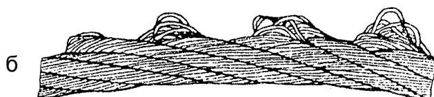
Рисунок 2.9.4 Выдавливание проволок прядей а – в одной пряди; б – в нескольких прядей
